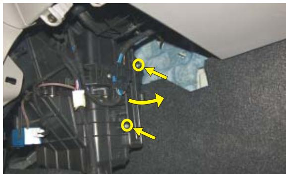
**(PL)** Odkręcić wkręty pokrywy filtra, usunąć pokrywę
